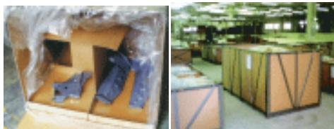
ベニア合板、プラスチックシートの代替として、自動車部品の輸出用梱包材などに幅広く仕様されており、防錆効果を付加したボードも用意しております。
